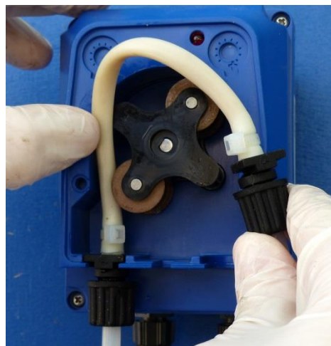
השחל בעדינות את הצינורית בחזרה למקומה. וודא שהלוחיות השחורות בקצוותיה מושחלות חזרה למקומן.
