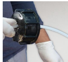
צינור היניקה מושחל דרך חור מכסה מיכל החומצה
